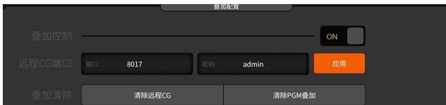
将 NSCaster X1 PRO 和 CG 编辑器通过网络连接后，按照 CG 编辑器上的操作按键，可将 CG 内容叠加到 NSCaster X1 PRO 的 PGM 通道。
